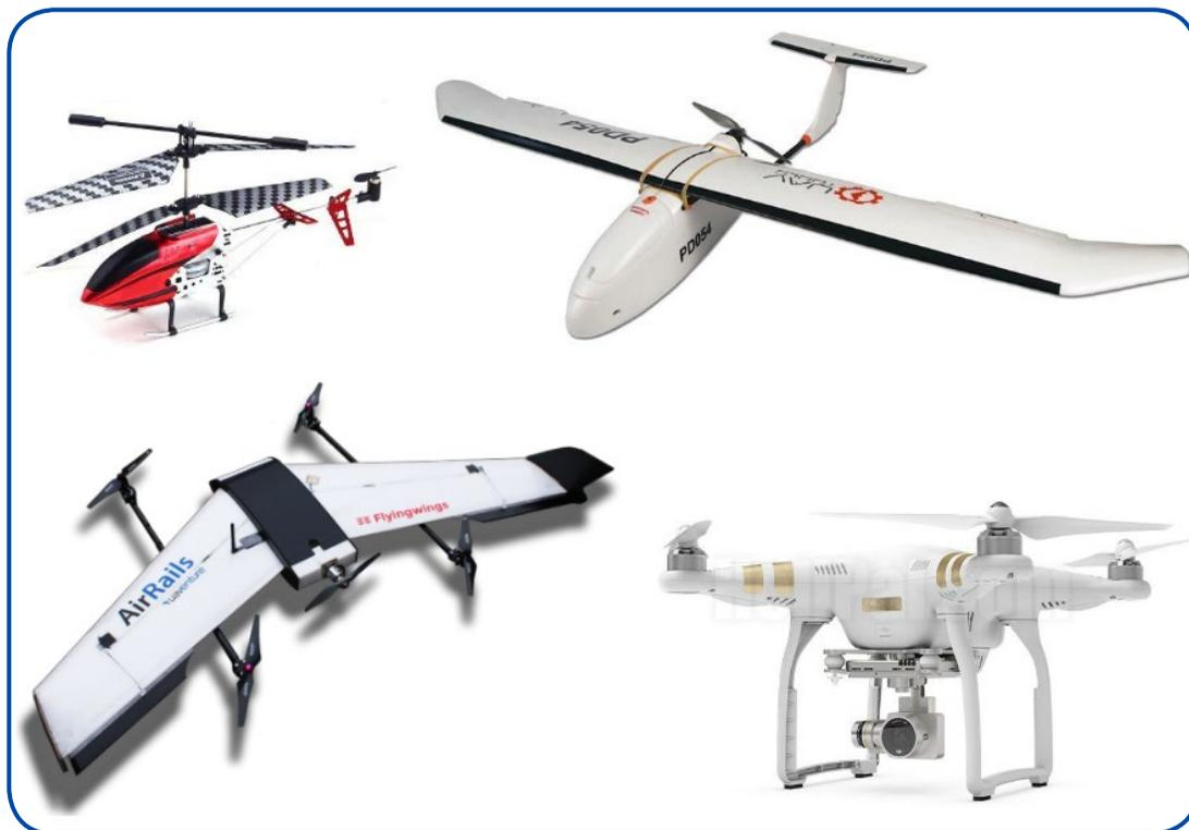
Generalmente el concepto de dron se asocia a los multicopteros. Estos cuentan con algunas ventajas: el despegue y aterrizaje vertical no requiere de pista, pueden mantener una posición fija en el aire, y tienen una gran capacidad para hacer maniobras en todas las direcciones.
