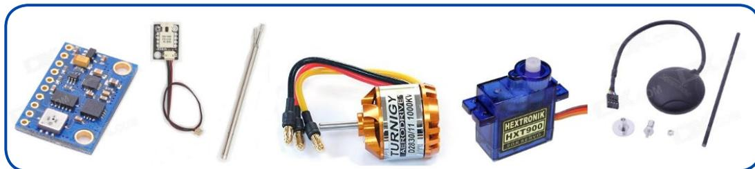
De izquierda a derecha: unidad inercial, sensor de viento, motor eléctrico de corriente continua para hélices, servomotor para control de alerones, GPS de gran alcance.
