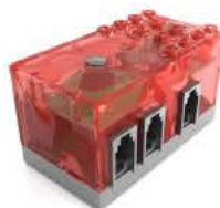
Ladrillo R8: cerebro que contiene la placa programable
