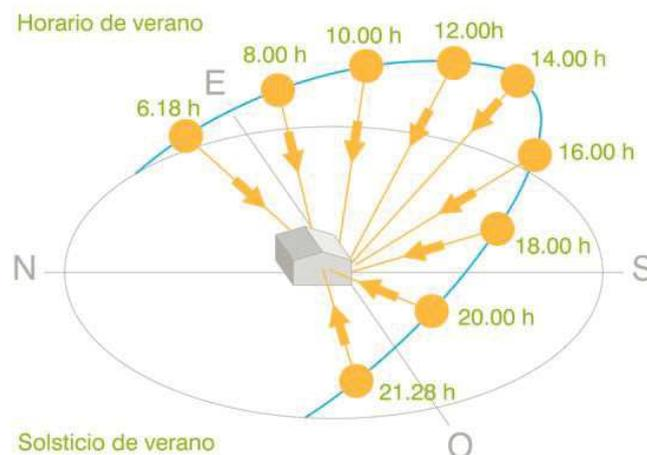
La iluminación natural es un factor muy importante a tener en cuenta a la hora de diagramar o diseñar un sistema de iluminación eficiente, aprovechando este recurso natural y gratuito podemos reducir hasta un 20% del consumo de energía y generar homogeneidad en el alumbrado interior
