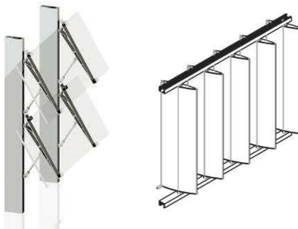
Figura 5-16: Detalle de parasoles verticales.
