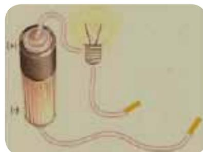
drán comprobar si son conductores (la lamparita se deberá encender) o no (la lamparita no se encenderá). A medida que vayan experimentando con cada material, registren los resultados en la tabla.
