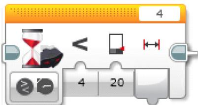
Este bloque **espera**, se activa al *comparar el sensor ultrasónico* mediante canal 4 y esté a una *distancia menor* que 20 cm.
