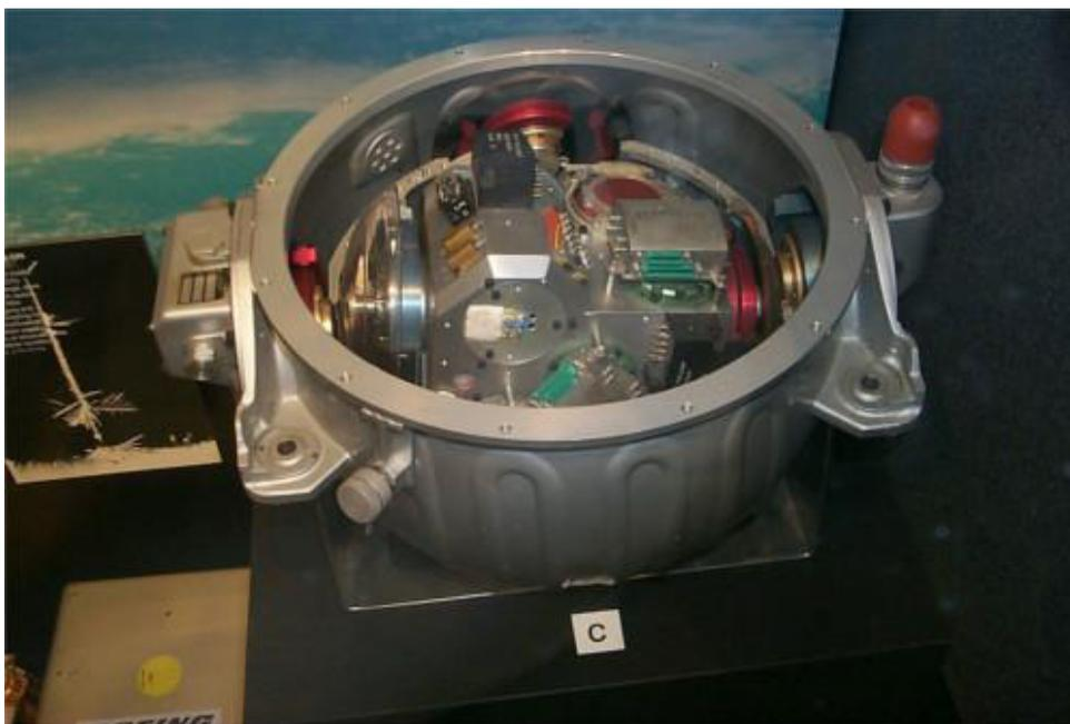
La de arriba es una imagen del sensor IMU del módulo de comando Apolo. Notarás lo grande que es, comparado con el que se encuentra en la placa SenseHat: esa es la diferencia entre la tecnología de 1975 y de la actualidad.
