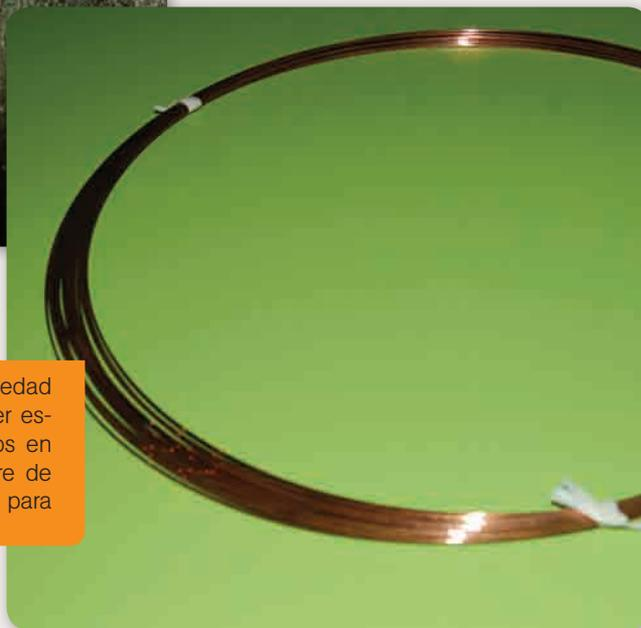
La **ductilidad** es la propiedad de los metales de poder ser estirados hasta ser convertidos en hilos. En la foto, un alambre de cobre de los que se utilizan para la conducción eléctrica.
