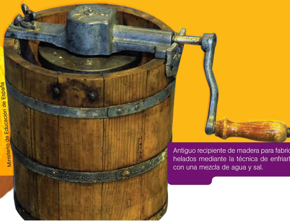
Antiguo recipiente de madera para fabricar helados mediante la técnica de enfriarlos con una mezcla de agua y sal.
