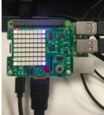
Vamos a probar este ejemplo, para fijar un color distinto en cada esquina de la pantalla de LED del Sense HAT. Necesitás usar el comando `set_pixel` command varias veces en el código, de esta manera:
